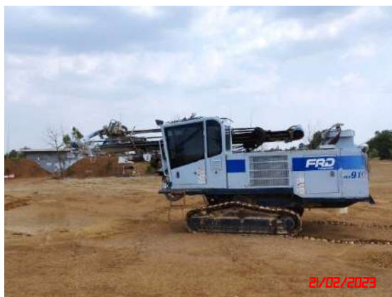
รูปที่ 13 เครื่องเจาะระเบิดที่ติดอุปกรณ์เก็บฝุ่นละออง
